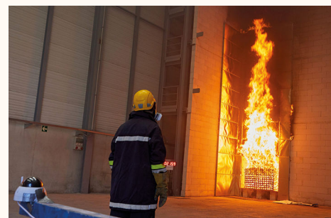
Figura 14. Ensayo según norma BS 8414 del laboratorio de seguridad frente a incendios de TECNALIA
