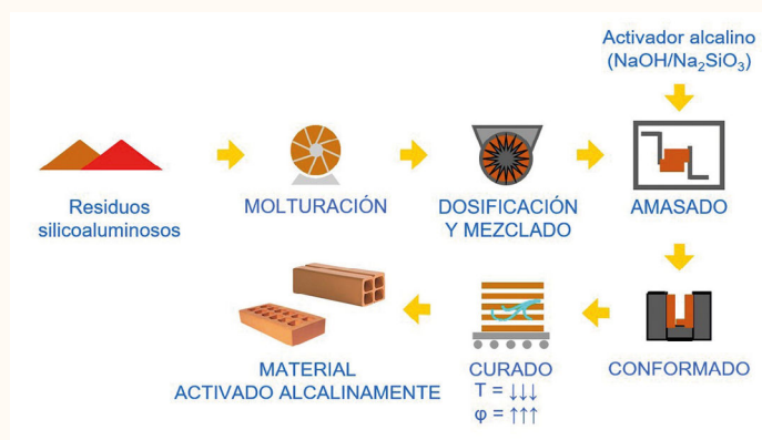
Figura 2. Proceso de fabricación de ladrillos activados alcalinamente.
