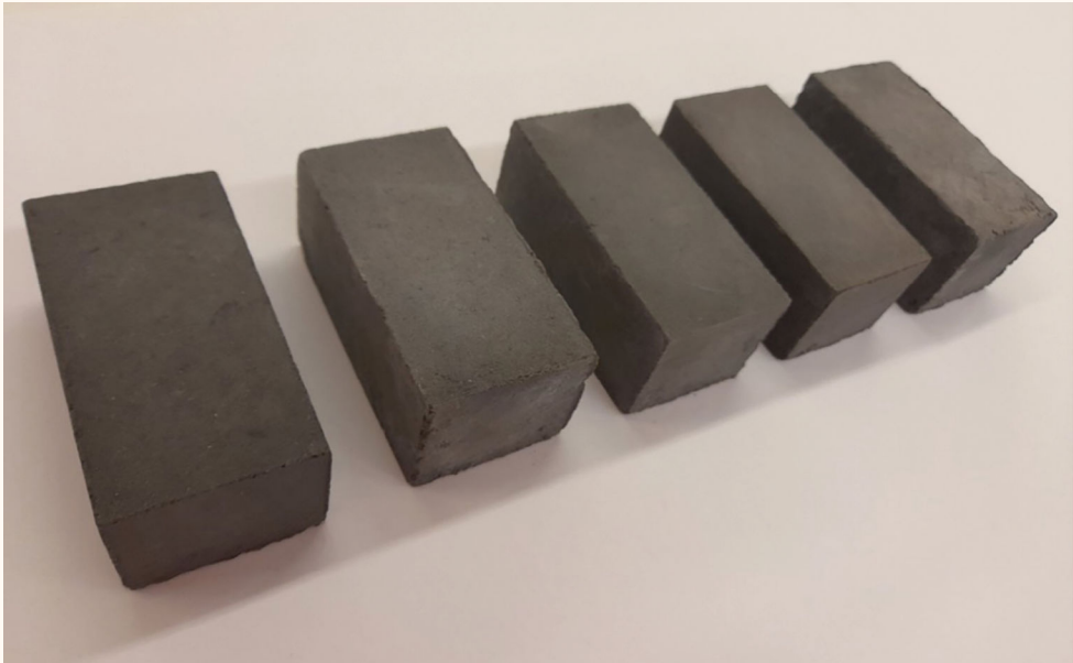
Figura 8. Ladrillos HYPOBRICK obtenidos a escala de laboratorio a partir de un residuo de tiesto cocido cerámico con pigmento negro.
