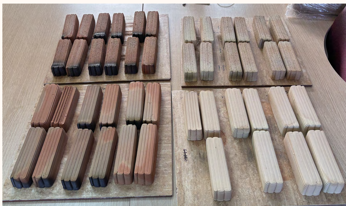
Figura 5. Probetas conformadas mediante fabricación aditiva LDM de diferentes arcillas y residuos en diferentes porcentajes.
