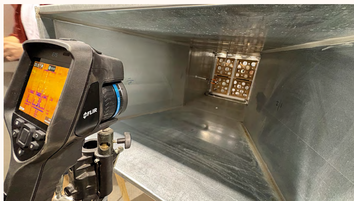
Figura 8. Ensayo de resistencia a flexión sobre probetas de material conformadas mediante fabricación aditiva LDM (imagen superior) y ensayo en túnel de viento para comprobar el rendimiento de enfriamiento de diferentes geometrías (imagen inferior).
